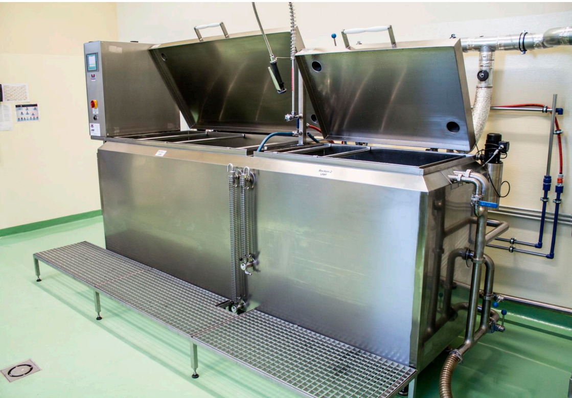
Abb.: Knochen-Mazerationsanlage mit 2 individuell regelbaren Prozess-Kammern.
